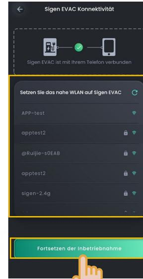
Wenn der Installateur eine Verbindung über den WLAN-Hotspot des Besitzers auswählen kann, stellen Sie eine Verbindung mit dem verfügbaren Hotspot her, gehen Sie zur Seite „Neues System einrichten“ und führen Sie die Schritte aus, die im Abschnitt „Bereits mit dem Internet verbunden“ beschrieben sind.
