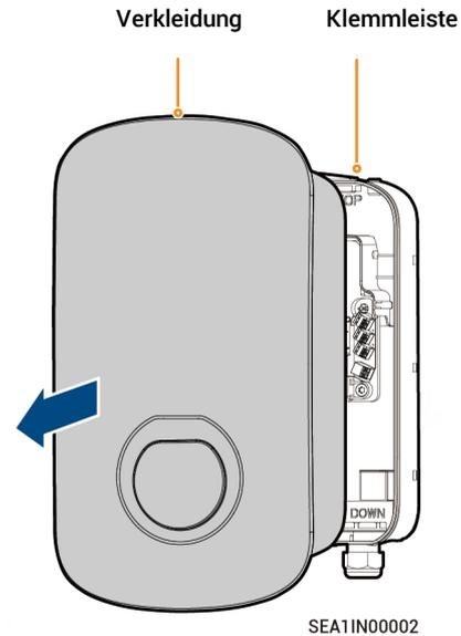
**3** Klemmleiste montieren und befestigen.
