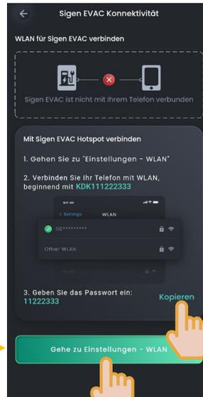
Verbinden Sie sich mit dem WLAN-Hotspot des Systems. Der Name des Hotspots entspricht der System-Seriennummer. Das Passwort wird auf der Benutzeroberfläche angezeigt.
