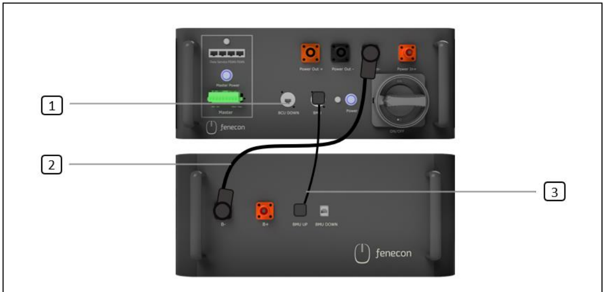
Abbildung 25: Verkabelung Master-BMS-Box und erstes Batteriemodul
