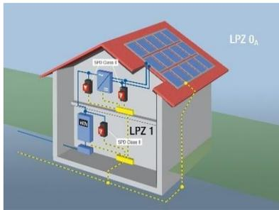
1. Gebäude ohne äußeren Blitzschutz benötigen ein DC SPD\*\* Typ II (gemäß EN\* 61643-31) mit 6 mm<sup>2</sup> Kabeln.
