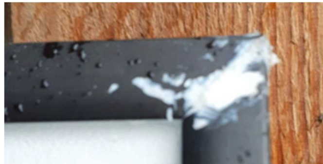
Abb.5 Silikonrückstände aus dem Produktionsprozess
