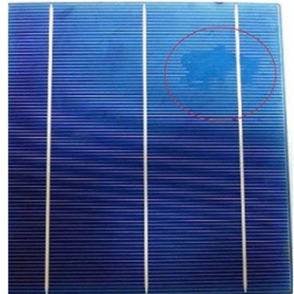
Abb.3 Defekt unter dem Glas
