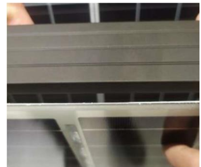
Abb.6 Fehlende Silikon- oder Klebeverbindung Rahmen mit internen Komponenten
