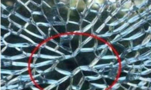
Abb.1 Spontane Rissbildung - geformter Punkt "Schmetterling"
