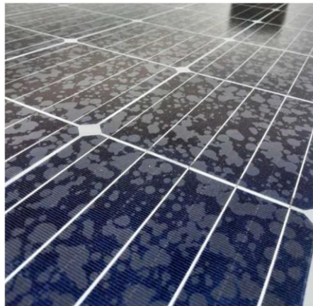
Abb.2 Feuchtigkeit unter dem Glas
