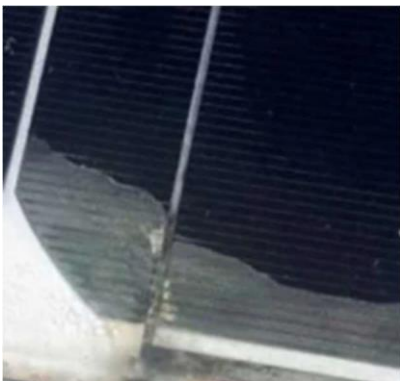
Abb.4 Delamination der EVA-Folie
