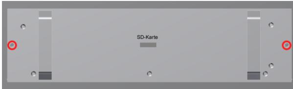
**Abbildung 30: Schrauben am Batteriewechselrichter**
